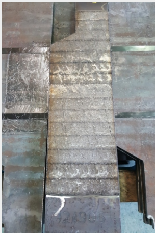
Zbrojenia młynów węgla Armaments coal mills
